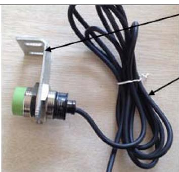
1. Место установки крепежного кронштейна датчика приближения.
