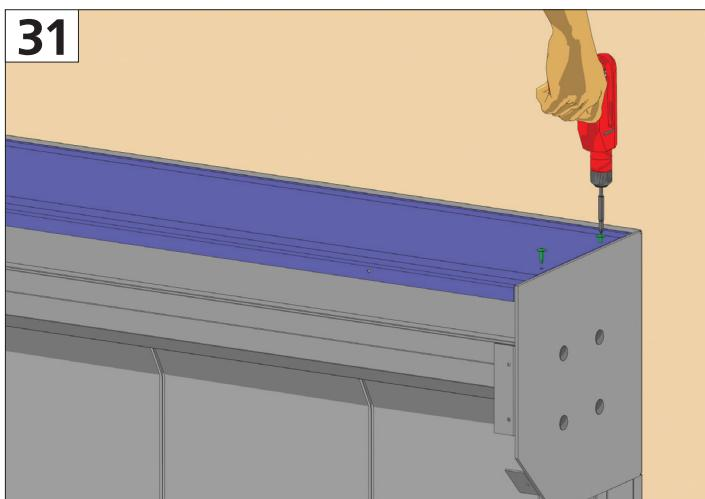
Закрепите крышку при помощи саморезов.
