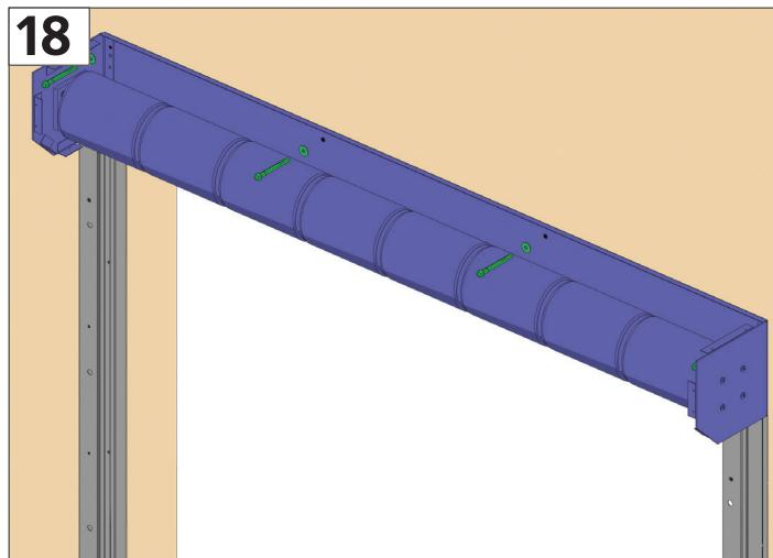
Закрепите короб при помощи анкерных болтов или саморезов по просверленным отверстиям.
