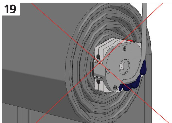
Для предотвращения попадания влаги, монтаж кабеля электродвигателя следует проводить с загибом (рис. 19-20).
