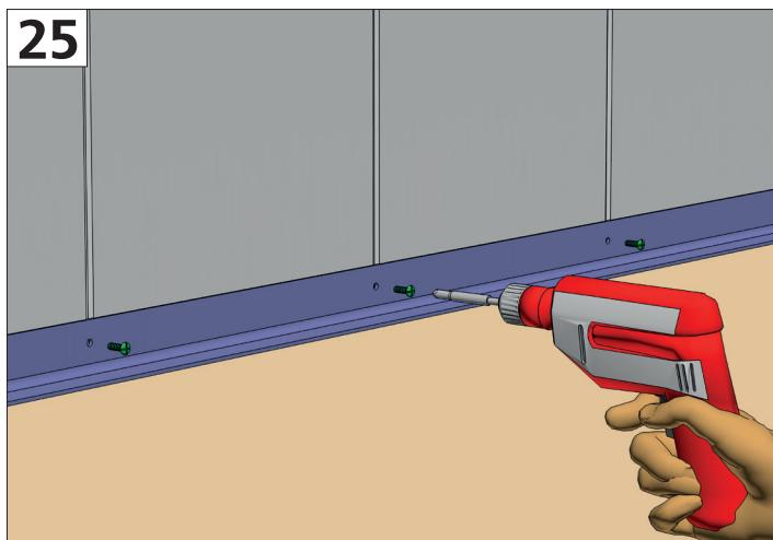
Закрепите утяжелитель при помощи болтов.
