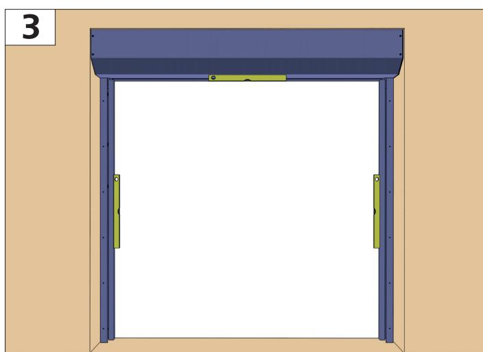
Каркас противопожарной шторы должен быть установлен строго вертикально (проверьте строительным уровнем).
