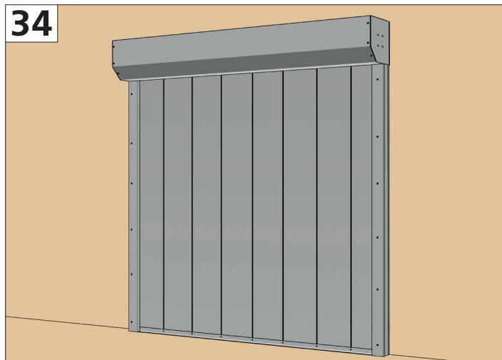
Проверьте правильность и надежность установки конструкции: поднимите и опустите несколько раз полотно противопожарной шторы.
