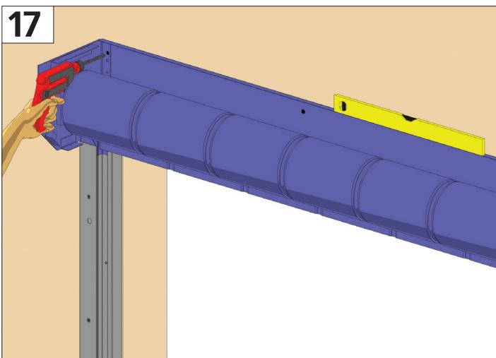
Установите короб по уровню. Просверлите отверстия в стене для анкерных болтов или саморезов.
