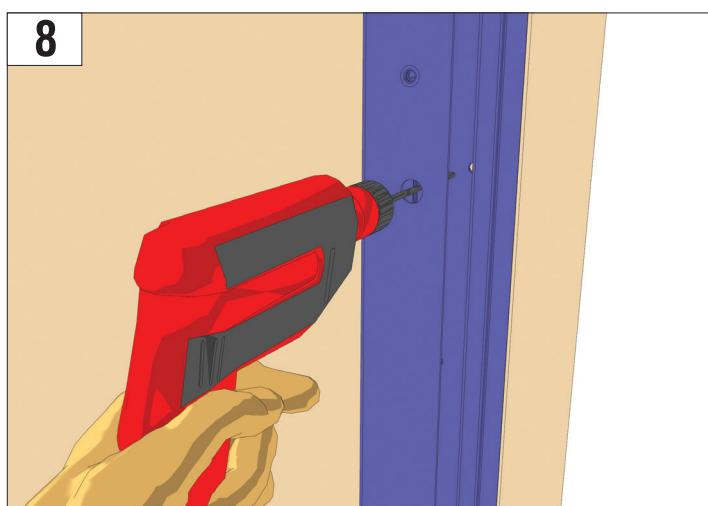
Просверлите отверстия в стене для самореза или анкерного болта.
