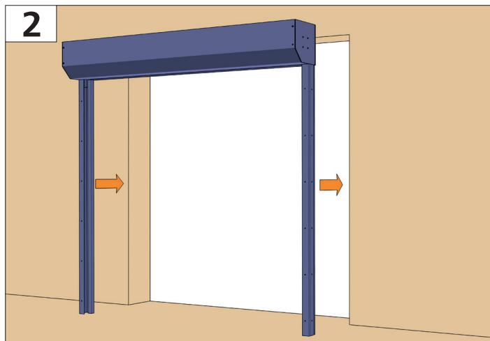
Вставьте каркас противопожарной шторы в проем.
