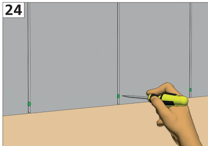
Проделайте отверстия в полотне для установки утяжелителя.
