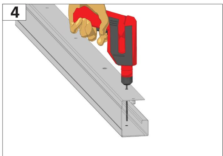
Направляющая состоит из двух частей. Небходимо разобрать направляющие: выкрутить болты и снять крышки.
