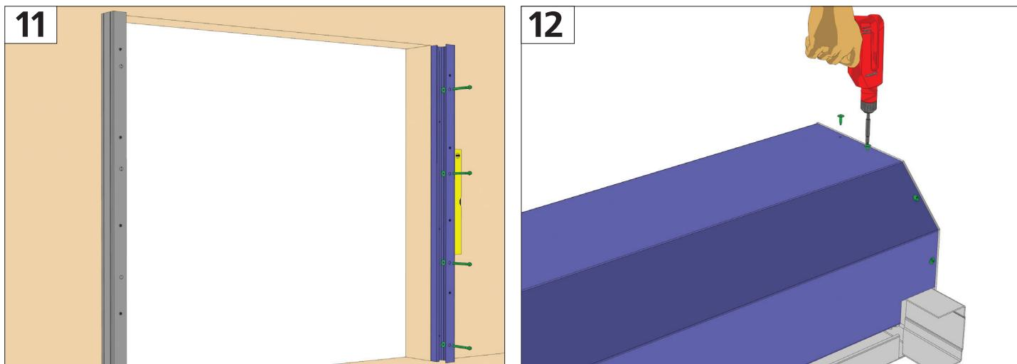
Установите и закрепите противоположную направляющую в проеме.
