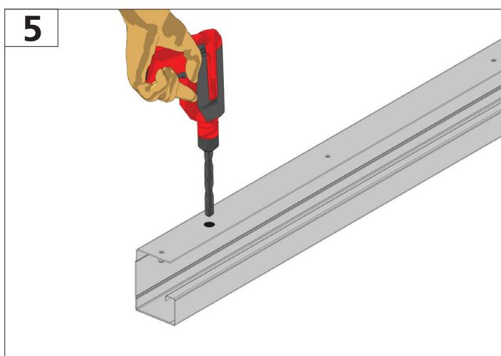
Просверлите отверстия в направляющих: 1) просверлите отверстия сверлом под саморез или анкерный болт насквозь (рис. 4); 2) рассверлите отверстия сверлом под биту (рис. 5).
