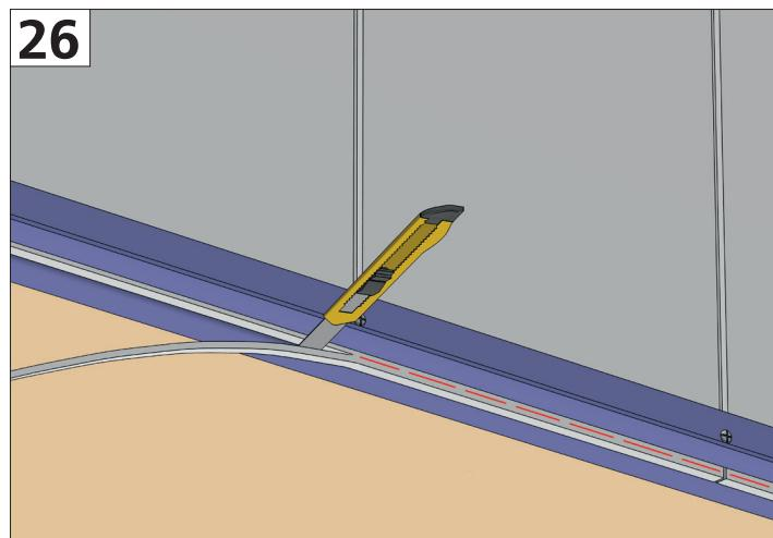
Обрежьте лишнюю часть полотна под утяжелителем.
