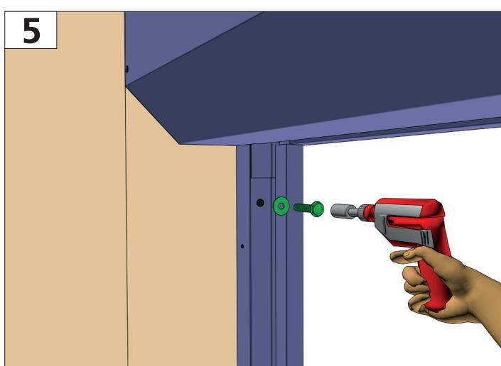
Закрепите по просверленным отверстиям направляющие при помощи саморезов (для стен из металла) или анкерных болтов (для стен из кирпича и бетона).
