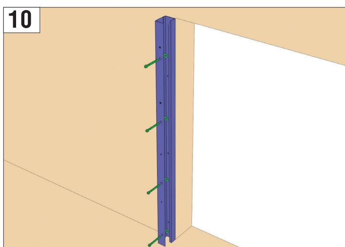
Закрепите по просверленным отверстиям направляющую саморезами или анкерными болтами в зависимости от материала проема. Для металла используются саморезы (рис. 9), для кирпича и бетона — анкерные болты (рис. 10).
