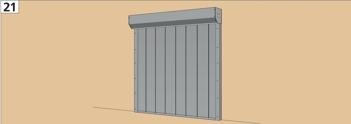
Проверьте правильность и надежность установки конструкции. Поднимите и опустите насколько раз полотно противопожарной шторы. Убедитесь в отсутствии посторонних звуков и в надежности крепления всех элементов.
