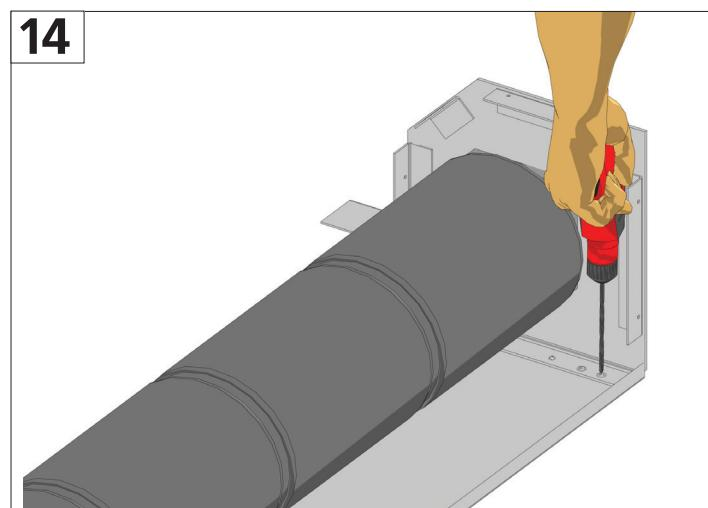
Просверлите отверстия в задней стенке короба под саморезы или анкерные болты.
